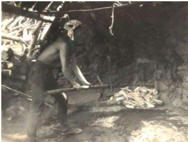
【写真-3②B】カナイボリで窯(炭)だし作業中。
