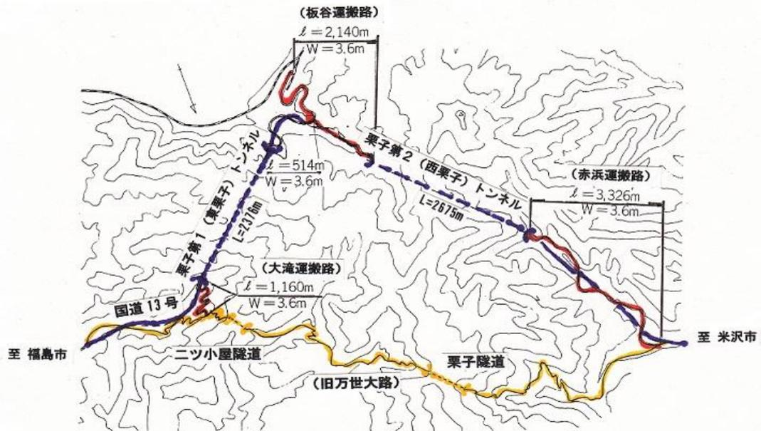
図一 3 栗子国道改築工事運搬道路計画平面図
