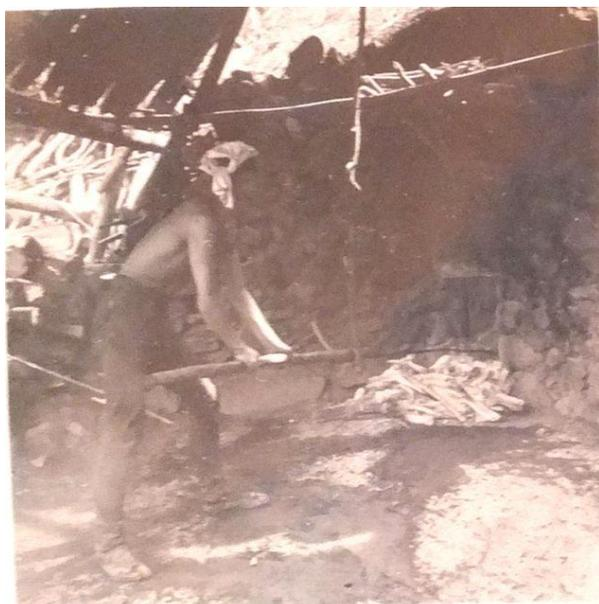
【写真炭焼-5】① カナイボリで窯(炭)だし作業中。
